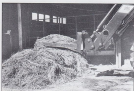
4. Pressa kniven nedåt med hjälp av lastarens dubbelverkande cylindrar
