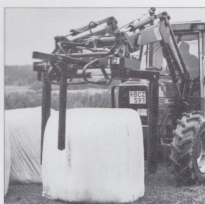
3. Tippa balen. Balstödet (extra tillbehör) utgör mothåll, så att tippningen sker lugnt och kontrollerat. "Öppna" redskapet.
